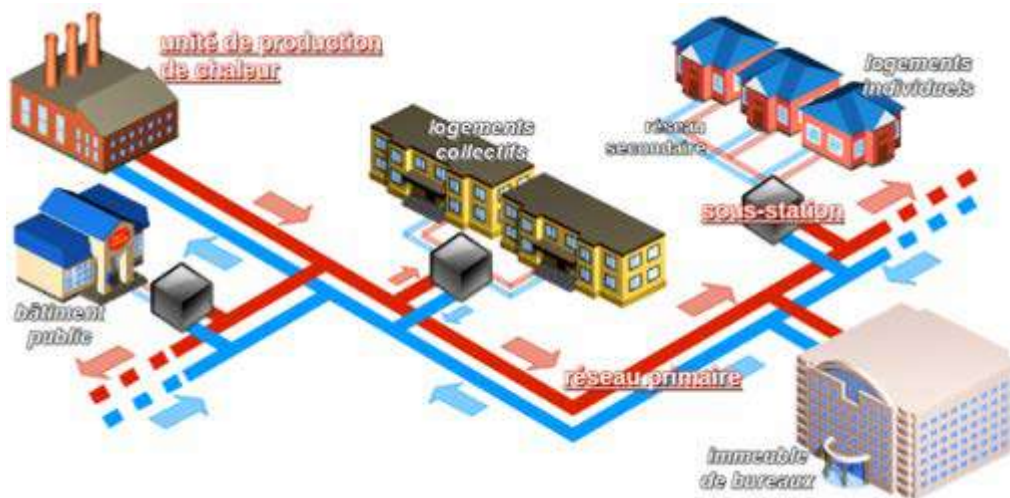
Figure 110 : Principe de fonctionnement d'un réseau de chaleur
