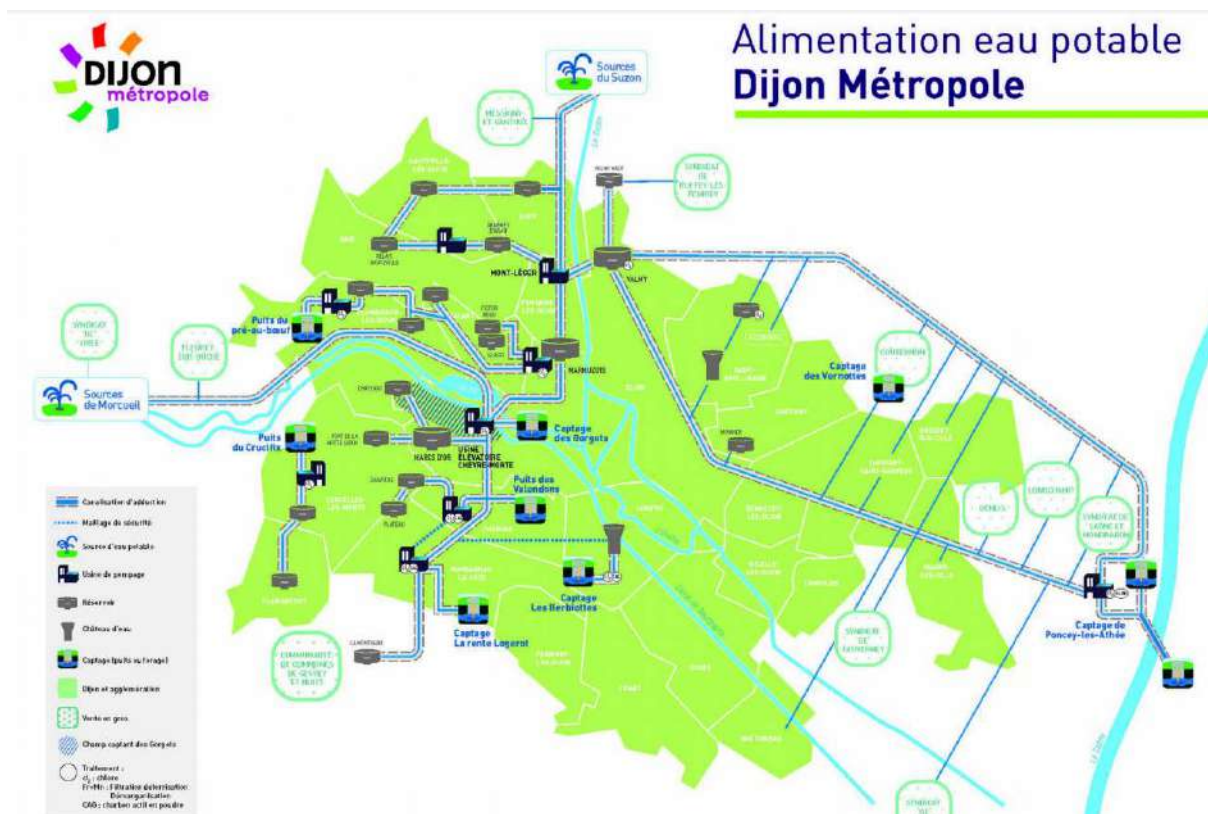
Figure 45 : fonctionnement global de l'alimentation en eau potable du Grand Dijon
