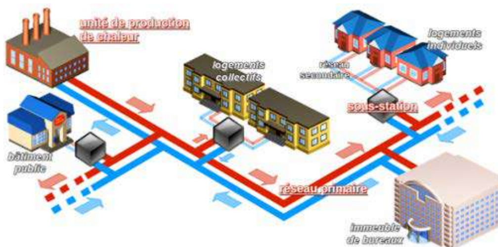
Figure 110 : Principe de fonctionnement d'un réseau de chaleur
