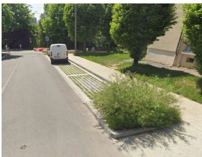
Figure 96 : principe de revêtement de parking
